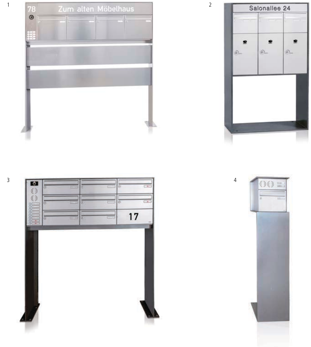
Abb. 1 Freistehende Anlage als Sonderlösung mit ILANO-Verkleidungsgestell aus Edelstahl V4A und Fußplatten zum Aufschrauben, geräuschgedämpfte und wasserabweisende Einwurfklappe RSK, RSA1-Klingelsystem und Namensschild, vorgerichtet für bauseitiges Kamera-Modul, Durchgraur flächenbündig ausgegossen mit LED-Beleuchtung, zwei Hinweisschilder zum bauseitigen Beschriften. Abb. 2 Freistehende Anlage als Sonderlösung mit ILANO-Verkleidungsgestell aus korrosionsgeschütztem und pulverbeschichtetem 10 mm Stahl-Flachmaterial, Renz-Paketkasten mit mechanischem Paketkastenschloss, geräuschgedämpfte und wasserabweisende Einwurfklappe RSK, RSA2-Namensschild, zweites Namensschild, farbig ausgelegte Eingravur. Abb. 3 Freistehende Anlage als Sonderlösung mit ILANO-Verkleidungsgestell aus korrosionsgeschütztem und pulverbeschichtetem 10 mm Stahl-Flachmaterial, RSA2-Klingelsystem und Namensschild, farbig ausgelegte Eingravur, vorgerichtet für bauseitiges Kamera-Modul. Abb. 4 Freistehende Anlage als Sonderlösung mit engangliegender Verkleidung aus Edelstahl V4A, Gestell aus korrosionsgeschütztem und pulverbeschichtetem 10 mm Stahl-Flachmaterial, geräuschgedämpfte und wasserabweisende Einwurfklappe RSK, RSA2-kompakt-Klingelsystem und Namensschild.
