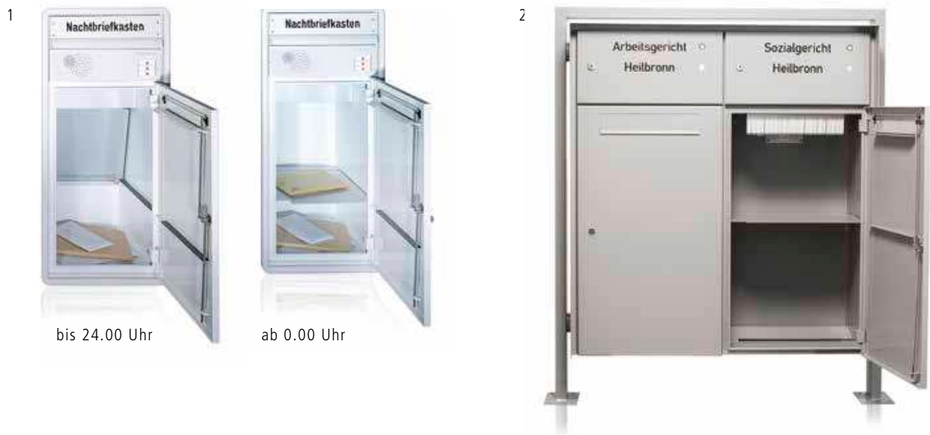
Abb. 1 Funktionsweise eines Tag-/Nachtbriefkastens, Unterputz-Anlage, mit rundem Putzabdeckrahmen RS3000, Tag-/Nachtumschaltung zur Fristenkontrolle, RSA1-Sprechfeld, Kunststoff-Klingelmodul, farbig ausgelegte Eingravur. Abb. 2 Tag-/Nachtbriefkasten mit beweglicher Fingersperre als Entnahmesicherung, enganliegende aufgefüllte Verkleidung, Rechteckrohrgestell 80 x 40 mm, Sonder-Einwurfklappe, RSA2-Klingelsystem, 3-Punkt-Verriegelung, farbig ausgelegte Eingravur.
