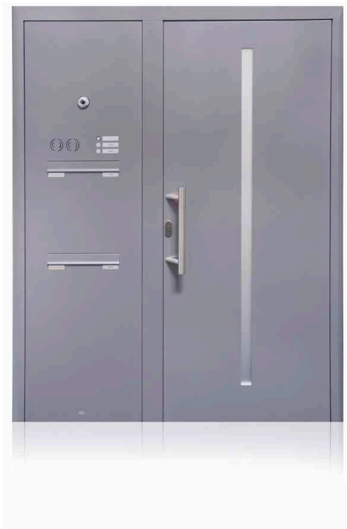
Abb. 1 Türseitenteil-Anlage aus hochwertigem Galfan-Stahl, Front flügelüberdeckend 35 mm dick mit thermischer Trennung, senkrechte Kästen, geräuschgedämpfte und wasserabweisende Einwurflappe RSK, RSA2-Klingelsystem und Namensschild, vorge- richtet für bauseitiges Kamera-Modul.
